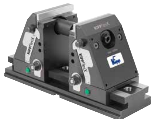
Klemmbacke beidseitig geschlossen -> Einsatz als Zentrisch-Spanner mit Niederzug
