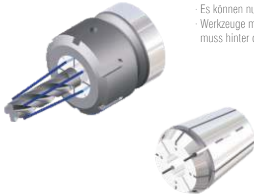
Abb.: Spannanzge mit »Cool Tool«-Bohrungen für Werkzeuge ohne Innenkühlung
