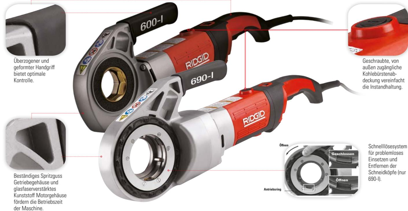
Überzogener und geformter Handgriff bietet optimale Kontrolle.
